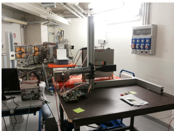
Fig. 6.8.2. Il fascio di protoni da 220 MeV osservato con un tracciatore al silicio seguita da un calorimetro – apparato utilizzato da Carlo Cividini, INFN Firenze.
