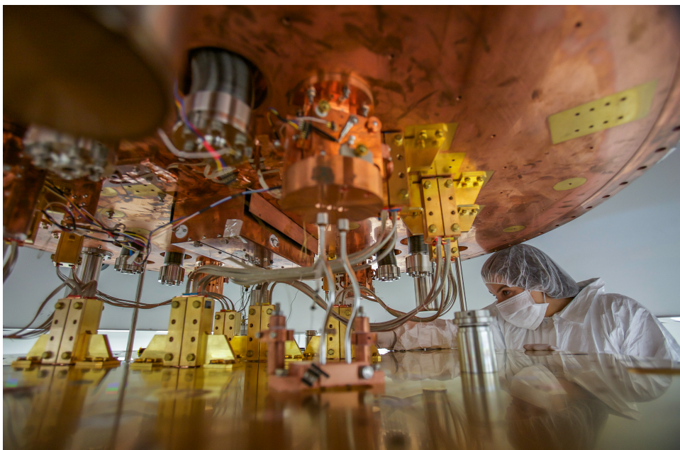
Fig. 6.1.2 Il criostato di Cuore durante l'assemblaggio dell'esperimento.
